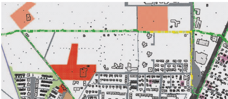
Bild 7: Lageplan des Leitungsabschnittes mit mangelhafter Umhüllung (gelb markiert)
