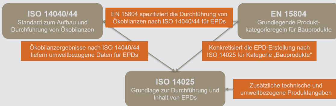
Bild 2: Normenkonstrukt der Umweltproduktdeklaration
