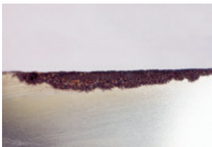
Abb. 3: Spongiose bei einem Graugussrohr
