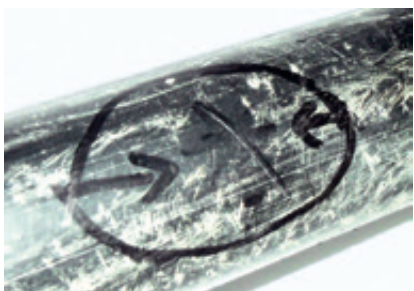
Abb. 2: Riss eines versprödeten PE-Rohres unter Punktlagerung
