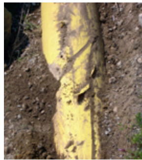
Abb. 1 a und b: Baggerzahnangriff an einer polyethylenumhüllten Gasleitung aus Stahl und einer Polyethylenleitung
