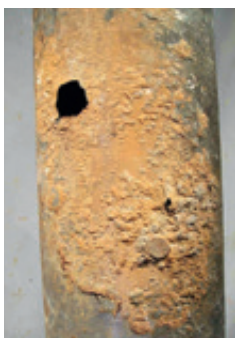
Abb. 6: Korrosionsschaden GGG 1. Generation
