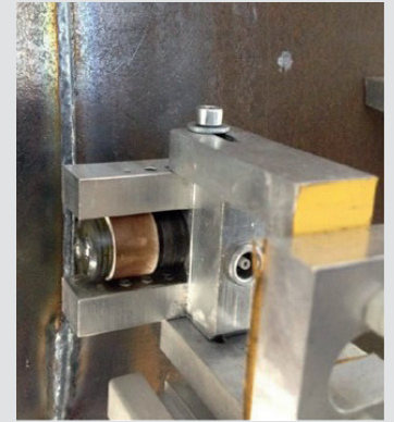
Bild 2: CAD-Modell des Prototyps für die Kombination aus Laserstrahlschweißen und Schweißnahtprüfung und verschmutzte Silikonrollen zur Ankopplung der Ultraschallprüfköpfe
