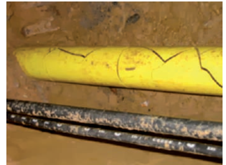
Bild 2: Punktlast – Rissbildung (gealtertes Material)
