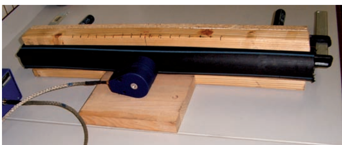
Bild 8: Experimenteller Aufbau zur Messung an PE 80-Rohren
