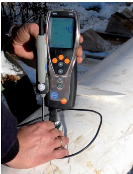
Bild 5: Sprödrisse in Polypropylen infolge Schlagbeanspruchung bei einer Temperatur von -4^{\circ}\text{C}
