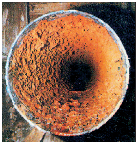
Bild 4: Inkrustationen auf ungeschützten Rohrrinnenflächen
